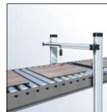
Ausführungen mit Hintergrundausblendung für die zuverlässige Erkennung verschiedener Objekte mit unterschiedlichen Farben.
