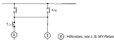
Im Falle des oben dargestellten Schaltkreises arbeitet das H3YN im Impulsbetrieb. Wenn die auf Seite C-73 dargestellte Schaltung verwendet wird, ist kein Zusatzrelais erforderlich.
