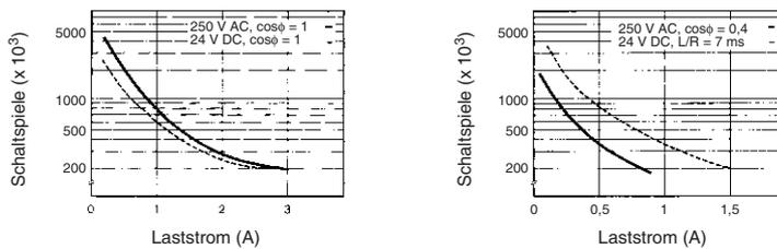
Referenz: Bei 125 V DC ( $\cos\phi = 1$ ) kann maximal ein Strom von 0,5 A geschaltet werden.
