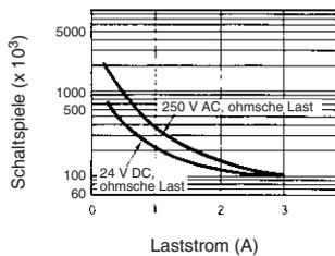
Referenz: Bei 125 V DC ( $\cos\phi = 1$ ) kann maximal ein Strom von 0,5 A geschaltet werden.
