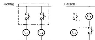
Verwenden Sie beim Aufbau eines selbsthaltenden oder selbstrücksetzenden Schaltkreises folgenden Sicherheitsschaltkreis mit dem H3YN in Kombination mit einem Zusatzrelais, wie z. B. einem MY-Relais.
