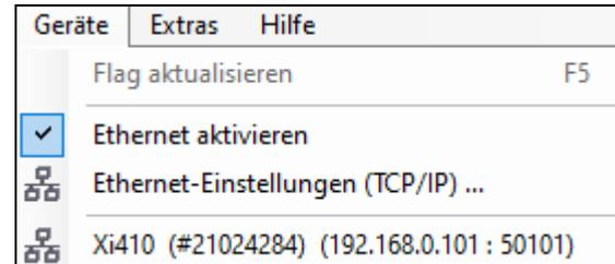
Um die entsprechenden Adress-Einstellungen vorzunehmen, gehen Sie im Menü auf **Geräte** und **Ethernet-Einstellungen (TCP/IP)**. Die Einrichtung erfolgt über die USB-Verbindung der Kamera.
