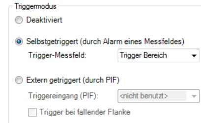
Bei **Extern getriggert (durch PIF)** erfolgt der Auslöser durch das Prozess-Interface (PIF). Dafür muss als erstes ein **Triggereingang (PIF)** gewählt werden. Die zur Verfügung stehenden Eingänge hängen vom verwendeten PIF ab.
