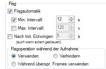
Über die Optionen im Punkt **Flagoperation während der Aufnahme** kann die Korrektur über **Verwenden** auch während einer Aufnahme aktiviert werden. Durch die Option **Verhindern** wird die Korrektur während einer Aufnahme deaktiviert. **Während übersprungener Frames verwenden** bedeutet, dass die Korrektur bei langsamen Aufnahmen (3 Hz und kleiner) automatisch zwischen den einzelnen Bildern erfolgt (Korrekturdauer ca. 250 ms).
