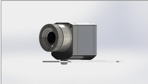
Abbildung 14: Montierte PI Kamera am Befestigungsblech
