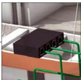
Ein Switch kontrolliert als MRP-Manager den PROFINET-Redundanzring.
