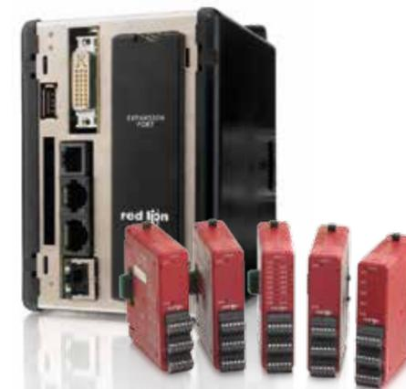
Verbindung zu Sensoren über CS-ERweiterungsmodule, einschließlich analoger und digitaler Eingänge, Dehnungsmessstreifen, Thermolemente und RTD-Eingänge
