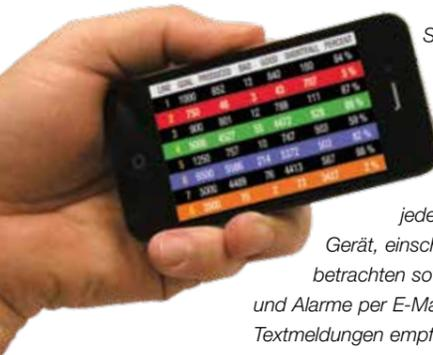
Sie können die Anzeigen oder Daten der ProductVity Station räumlich abgesetzt von einem PC oder jedem Web-fähigen Gerät, einschließlich Smartphones, betrachten sowie Ereignisse und Alarmer per E-Mail oder SMS-Textmeldungen empfangen.
