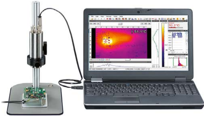
Mikroskopoptik Xi 400 für die Analyse kleinster Komponenten
