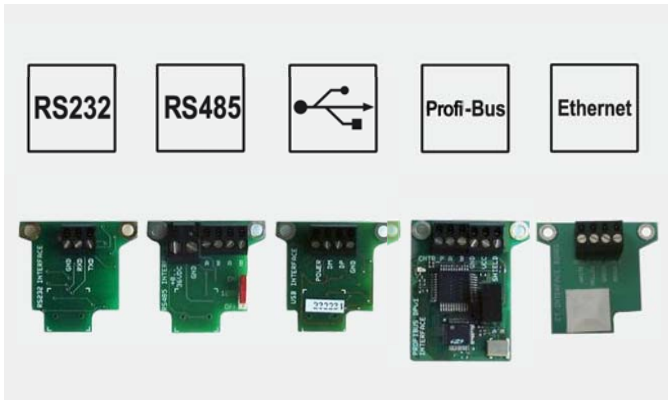
Ausgänge und Schnittstellen (analog und digital), als Beispielbild: steckbare, digitale Schnittstellenmodule der Elektronikbox
