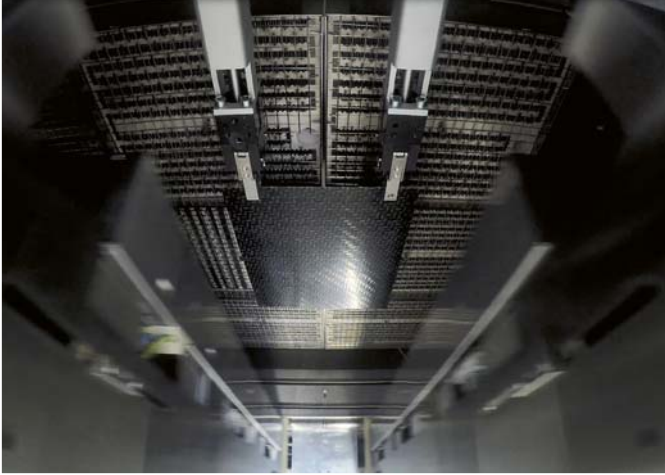
Kleiner CT LT-Messkopf mit Laminar-Freiblaseinrichtung in einer Thermoformmaschine
