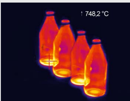
Hot-Spot-Messung bei der Herstellung von Glasflaschen
