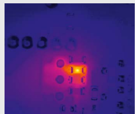
Aufnahme einer Leiterplatte mit Mikroskopoptik PI 640i
