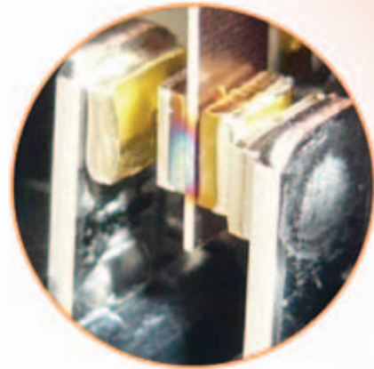
Mit Gold beschichtete Kontakte für einen optimalen Schutz
