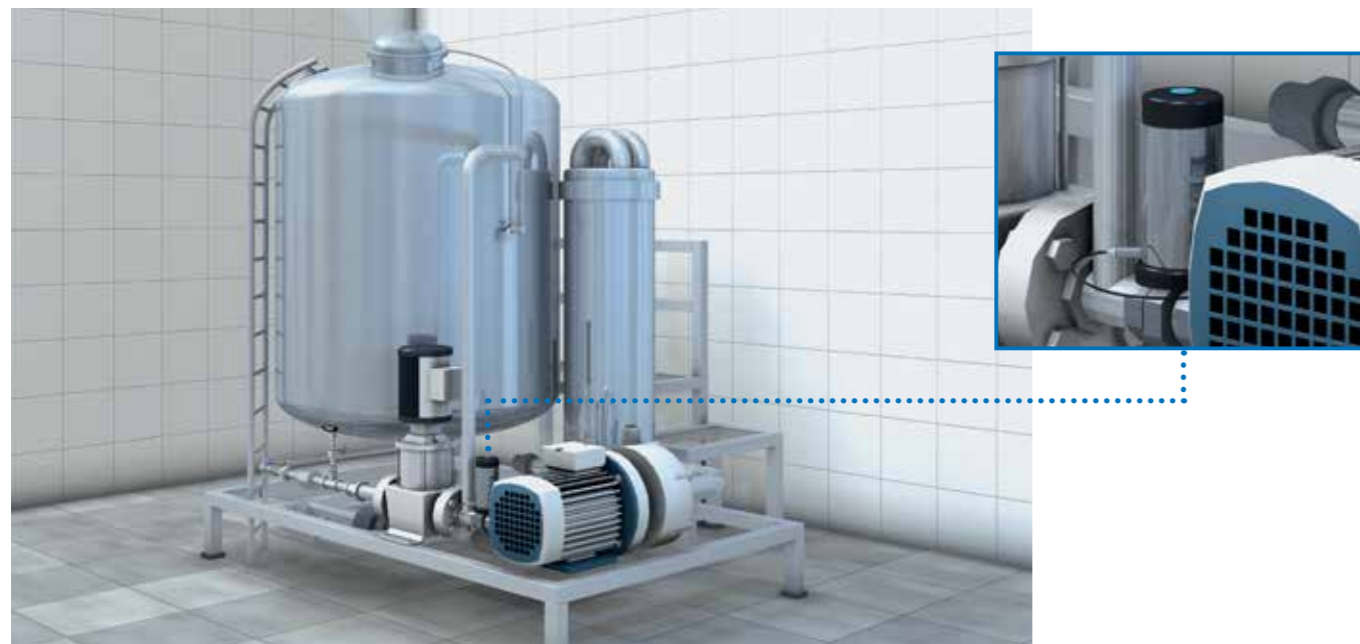
Kontrolle der Positionierung von Metallkomponenten in Mischanlagen bei direktem Kontakt mit Getränken oder aktiven Chemikalien
