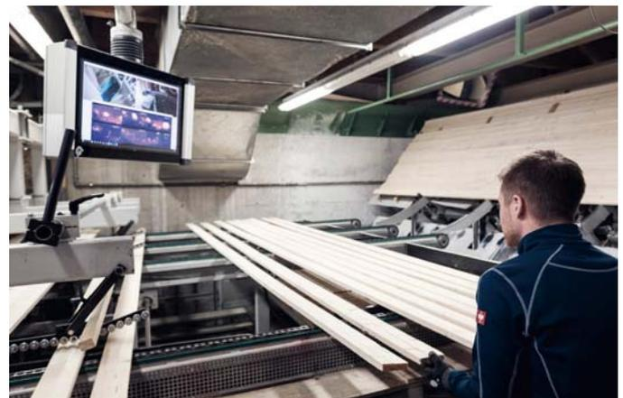
Die Software PIX Connect ermöglicht die Überwachung von Hobelanlagen.
