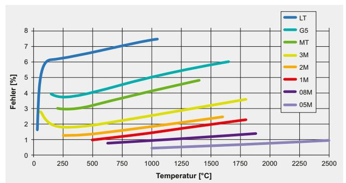
Messfehler bei 10 Prozent falsch eingestelltem Emissionsgrad in Abhängigkeit von der Wellenlänge und Objekttemperatur (LT: 8–14  $\mu\text{m}$ ; G5: 5  $\mu\text{m}$ ; MT: 3,9  $\mu\text{m}$ ; 3M: 2,3  $\mu\text{m}$ ; 2M: 1,6  $\mu\text{m}$ ; 1M: 1,0  $\mu\text{m}$ ; 08M: 800 nm; 05M: 525 nm).
