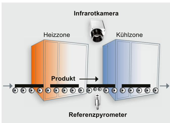
Wärmemessung an einer Glashärtungsanlage mit Infrarotkamera und Referenzpyrometer
