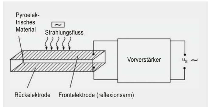
Prinzipieller Aufbau eines pyroelektrischen Detektors
