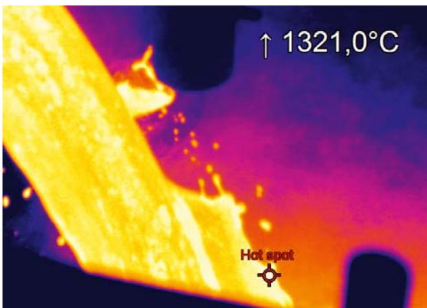
*Aufgrund des durchgängigen Messbereichs von 900 bis 2450 °C eignet sich die PI 05M besonders für die Temperaturmessung von Metallschmelzen.*
