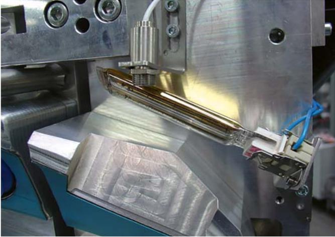
*Infrarottemperaturmessung in Verpackungsmaschinen*
