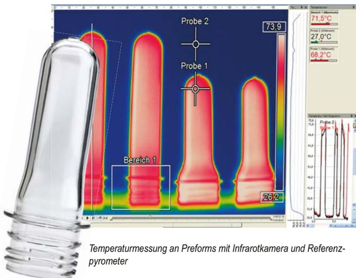
Temperaturmessung an Preforms mit Infrarotkamera und Referenzpyrometer
