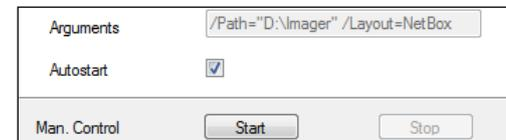
Sollte die Applikation aus irgendeinem Grund nicht mehr ordnungsgemäß funktionieren (Software-Absturz), startet das NetBox Control Center diese bei gesetzter Autostart-Funktion automatisch neu (Software Watchdog).
