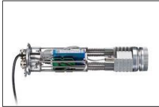
Abbildung 52: Cooling Jacket Advanced (Extended-Version) mit USB-Server und Industrielles PIF
