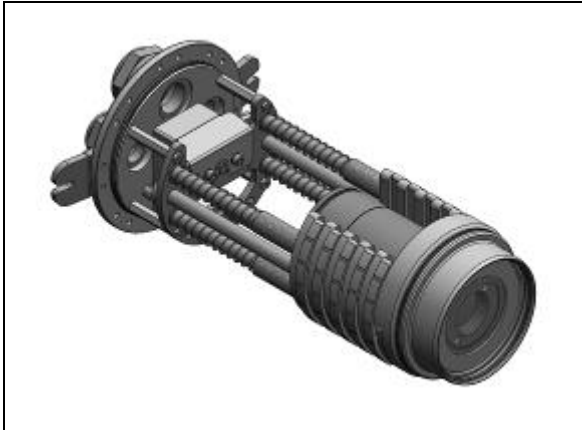
Abbildung 36: Frontaufsatz mit Pyrometer im Chassis
