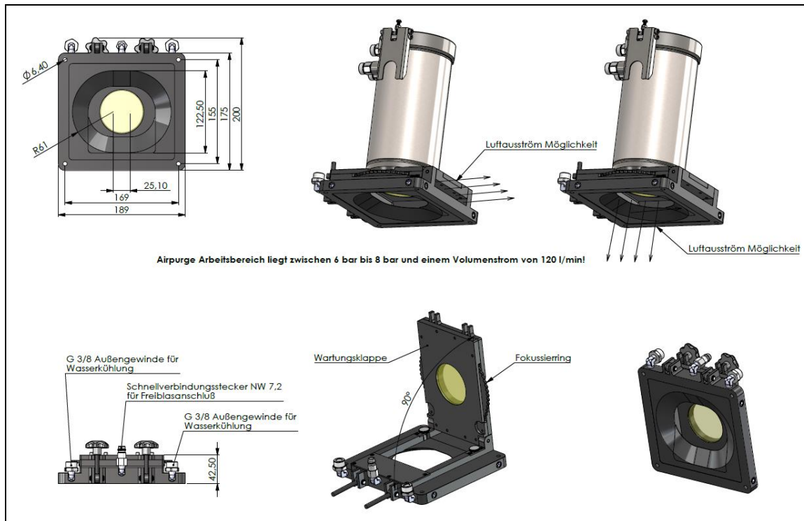
Abbildung 3: Abmessungen vom laminaren Freiblasvorsatz
