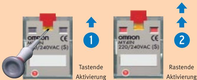
Schieben Sie die Prüftaste in die erste Stellung für tastenden Prüfbetrieb. Drücken Sie dann mit einem isolierten Werkzeug die gelbe Taste, um die Relaiskontakte zu schalten.
