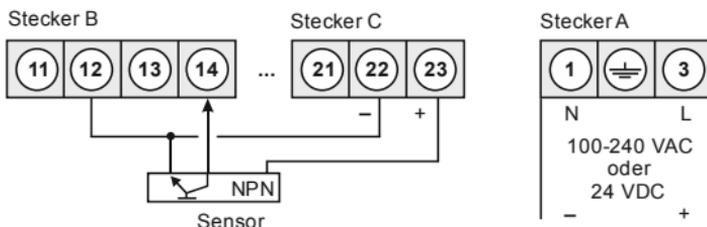
**Sensor mit NPN-Ausgang und erforderlichem Widerstand**
