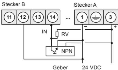
**Sensor mit NPN-Ausgang, erforderlichem ext. Widerstand und 24 VDC Geberversorgung**
