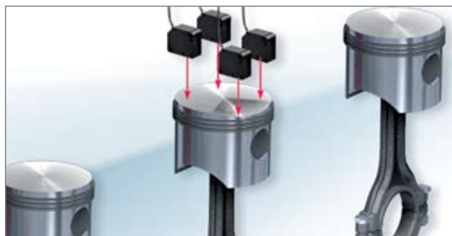
▲ Prüfung von Kolben auf Planheit
