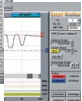
Schwelleinstellung durch grafische Drag-&-Drop-Funktion.
