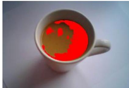
Isothermische Überblendung des visuellen Bildes zu 0 %
