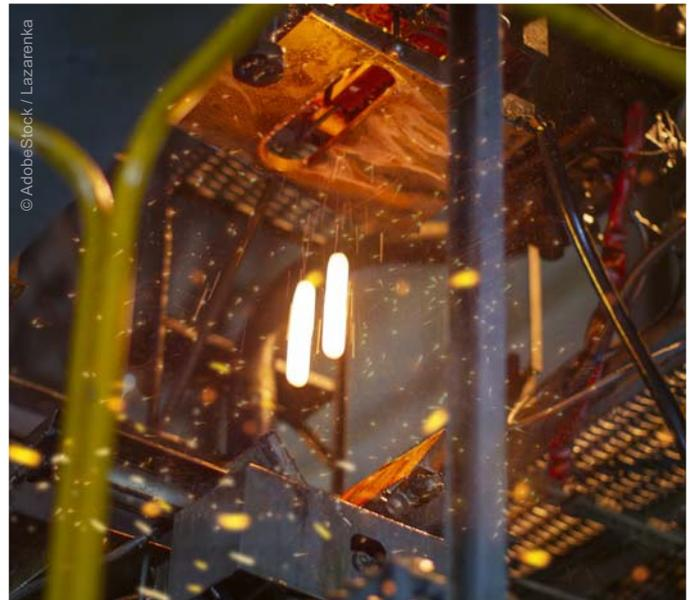
*Temperaturüberwachung von geschmolzenen Glaspfropfen in Glashärtemaschinen*
