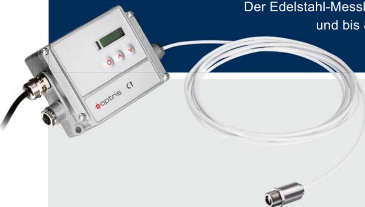
Der Edelstahl-Messkopf des IR-Thermometers ist **extrem klein** und bis 85 °C Umgebungstemperatur ohne Kühlung einsetzbar. Der Messbereich liegt zwischen 100 °C und 1650 °C.
