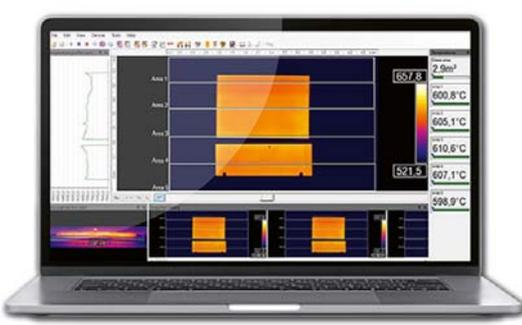
Überwachung der Temperaturen von Glasscheiben mit der Software PIX Connect
