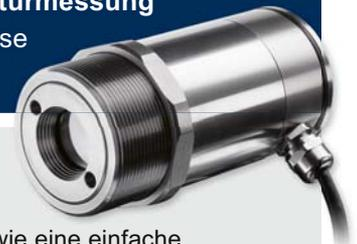
Die **Infrarot-Thermometer optris CTlaser 05M / 1M / 2M / 3M** wurden speziell zur **Temperaturmessung an Metalloberflächen und flüssigen Metallen** entwickelt. Sie zeichnen sich durch kurzwellige Spektralbereiche von 525 nm (05M), 1 µm (1M), 1,6 µm (2M) und 2,3 µm (3M) aus, die auch Messfehler bei Emissionsgradveränderungen minimieren. Der Temperaturbereiche der Thermometer liegen zwischen 50 °C und 2200 °C.
