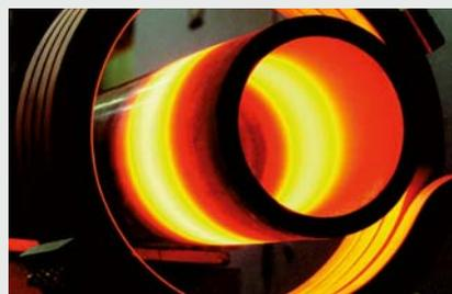
Induktiv erwärmtes Rohr
