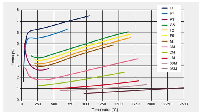
Messfehler bei 10 Prozent falsch eingestelltem Emissionsgrad in Abhängigkeit von der Wellenlänge und Objekttemperatur (LT: 8 - 14  $\mu\text{m}$ ; P7: 7,9  $\mu\text{m}$ ; P3: 3,43  $\mu\text{m}$ ; G5: 5  $\mu\text{m}$ ; MT: 3,9  $\mu\text{m}$ ; F2: 4,24  $\mu\text{m}$ ; F6: 4,64  $\mu\text{m}$ ; 3M: 2,3  $\mu\text{m}$ ; 2M: 1,6  $\mu\text{m}$ ; 1M: 1,0  $\mu\text{m}$ ; 08M: 800nm; 05M: 525 nm)
