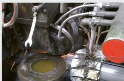
Temperaturüberwachung der Rohrränder kurz vor dem Verschweißprozess
