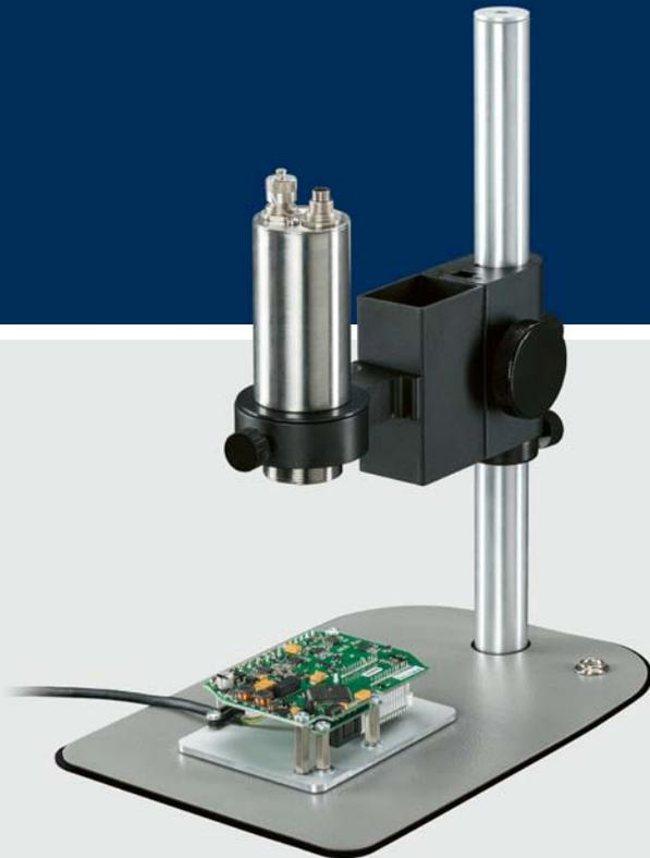
Die Mikroskopoptik des Xi 400 ermöglicht eine zuverlässige Temperaturmessung an kleinsten Objekten ab 240 µm. In Kombination mit einem geeigneten Stativ ermöglicht dies die professionelle Messung von Leiterplatten und Bauteilen in der Elektronikindustrie.
