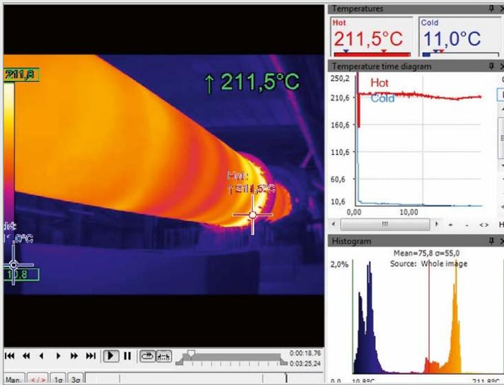
Neben Einzelbildern können mit der Software auch Videosequenzen radiometrisch aufgezeichnet werden. Dies ermöglicht eine detaillierte spätere Analyse der Daten und Auswertung der Messergebnisse.
