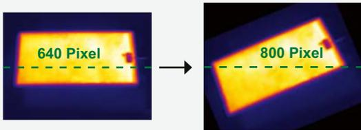
Erweiterung der Anzahl der Pixel von z. B. 640 Pixel auf 800 Pixel durch Nutzung der Bilddiagonale
