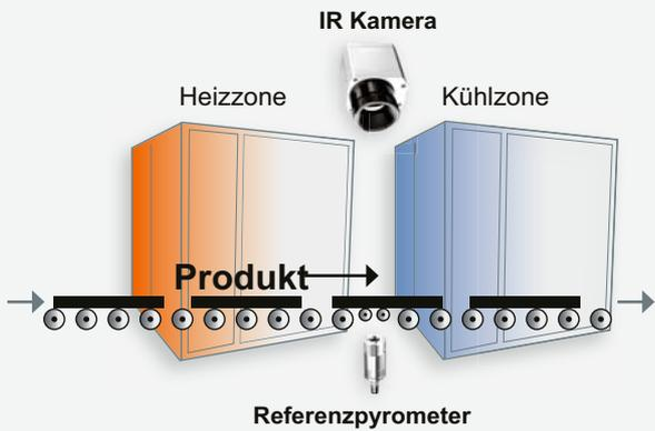
Indirekte Visualisierung der Wärmeverteilung in Öfen über Kamera-Installation am Ofenausgang
